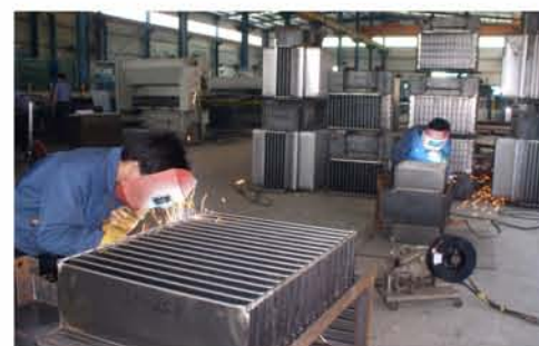
▼ 2005年10月4日箱体车间油变焊接
